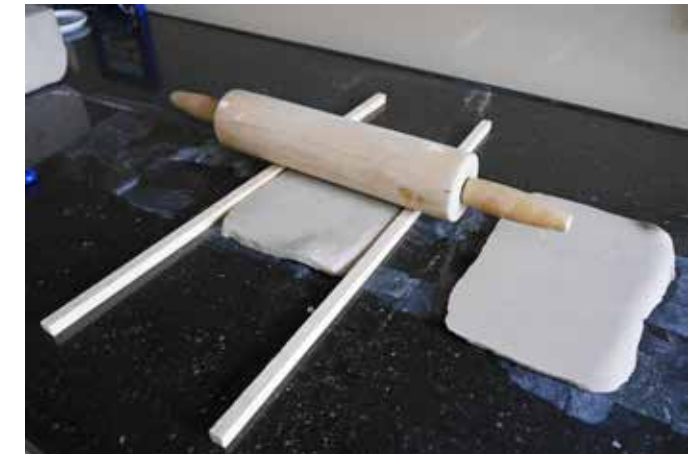
Abb. 3: Eine plane Tonfläche mit dem Wellholz und Hilfshölzern auswellen.
