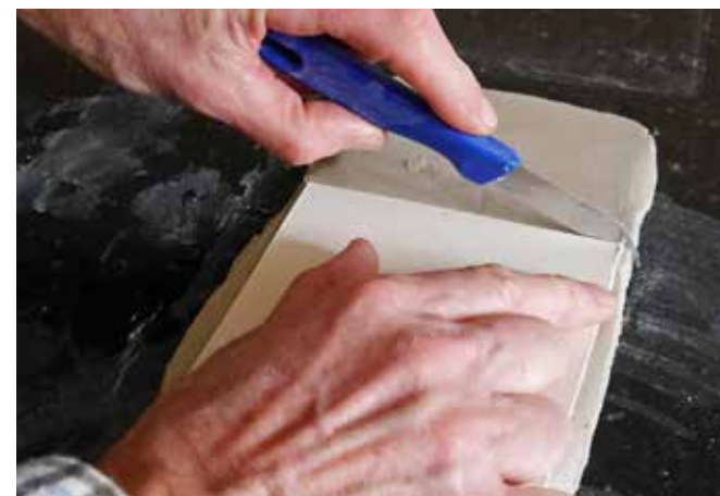
Abb. 4: Fliesen mit Hilfe eines Papierquadrats in der gewünschten Größe ausschneiden.
