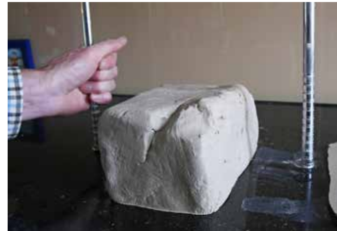
Abb. 2: Eine plane Tonfläche mit dem Tonschneidebügel ausschneiden.
